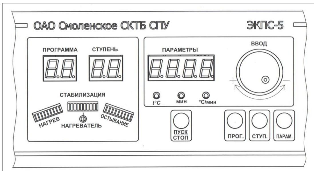
Рисунок 2 – Лицевая панель пульта управления электропечи
